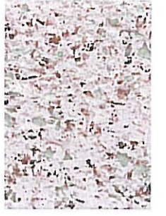
Prefabricat de formigó reciclat amb matxaca de vidre
