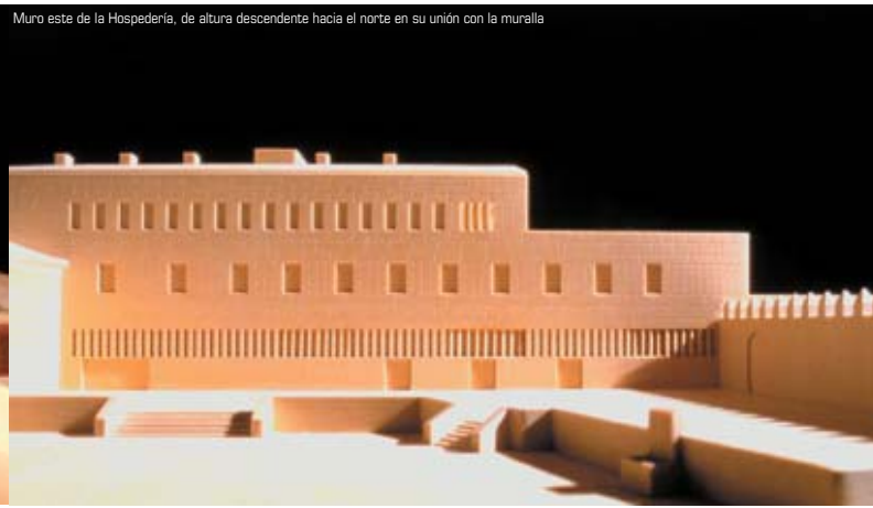
Muro este de la Hospedería, de altura descendente hacia el norte en su unión con la muralla
