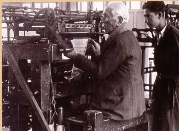
Teler manual quadrat tipus William Lee. (conservat a CRTTT- Escola de Teixits de Canet de Mar)
