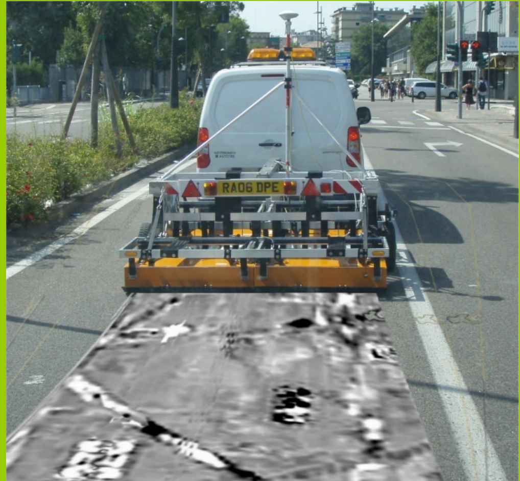
Sistema STREAM-X muntat en vehicle. Adquireix simultàniament 16 canals de 200MHz amb precisió centimètrica
